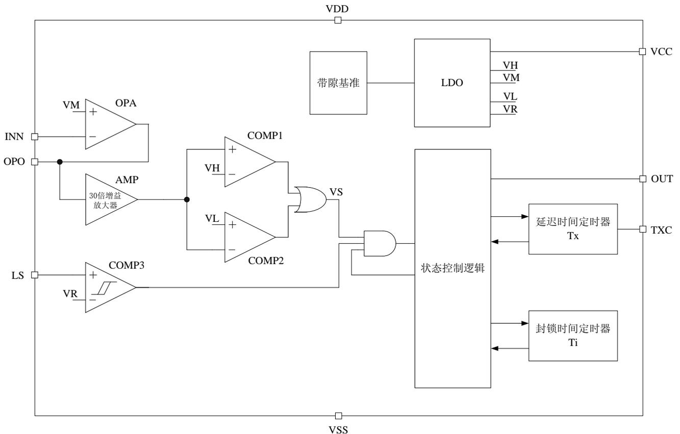
图 2: RS012 的内部电路方框图
