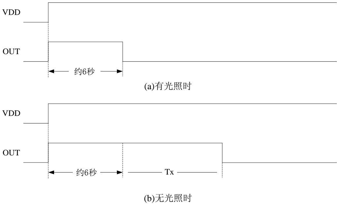
图 3: 上电热机时 OUT 端输出波形
