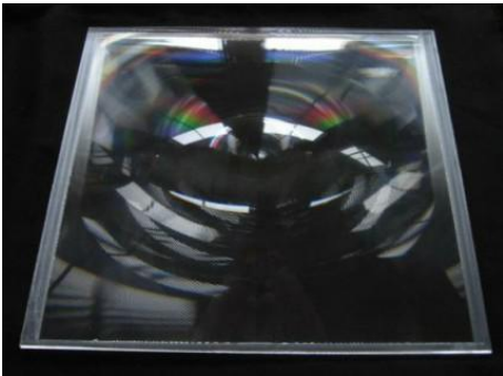
型号: HW2682502 尺寸: 268*256 焦距: 250 环距: 1 厚度: 3.75 材质: PMMA
