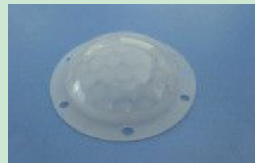
型号: 8605-2A 【051】 焦距: 15mm 角度: 360° 距离: 8m 尺寸: 直径 44.5mm
