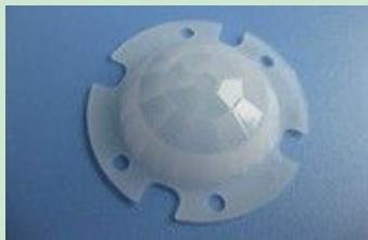
型号: 8603-3 【046】 焦距: 17.5mm 角度: 360° 距离: 8m 尺寸: 直径 45.9mm
