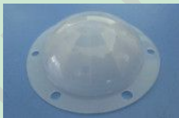
型号: 8605-2 【050】 焦距: 15mm 角度: 360° 距离: 8m 尺寸: 直径 44.5mm
