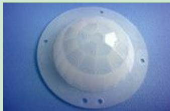
型号: 8603-4 【047】 焦距: 17.5mm 角度: 360° 距离: 8m 尺寸: 直径 45.9mm
