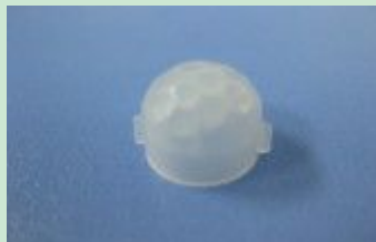
型号: 8006 【036】 焦距: 7.5mm 角度: 120° 距离: 6m 尺寸: 外径 15mm 内径 14mm
