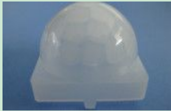
型号: 8002-3 【004】 焦距: 12mm 角度: 120° 距离: 10m 尺寸: 直径 24mm
