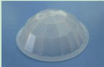
型号: 8603-5 【049】 焦距: 12mm 角度: 360° 距离: 10m 尺寸: 直径 35mm
