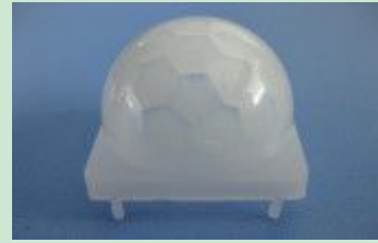
型号: 8002-2B 【003】 焦距: 12mm 角度: 100° 距离: 10m 尺寸: 直径 23mm
