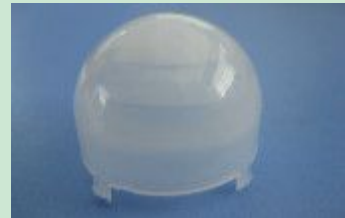
型号: 8003-1 【010】 焦距: 10.5mm 角度: 100° 距离: 7m 尺寸: 直径 23mm
