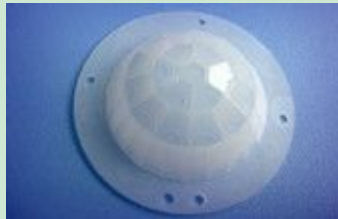
型号: 8603-4 【047】 焦距: 17.5mm 角度: 360° 距离: 8m 尺寸: 直径 45.9mm
