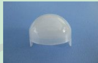
型号: 7709-1 【019】 焦距: 7.6mm 角度: 90° 距离: 6m 尺寸: 直径 21mm
