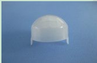
型号: 7709-1B 【020】 焦距: 7.6mm 角度: 90° 距离: 6m 尺寸: 直径 20.7mm 高 17mm
