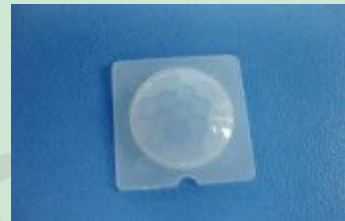
型号: 8307-2 【031】 焦距: 12mm 角度: 60° 距离: 5m 尺寸: 直径 14mm
