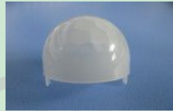
型号: NL-02 【006】 焦距: 10.05mm 角度: 100° 距离: 10m 尺寸: 直径 23.5mm 高 12.3mm
